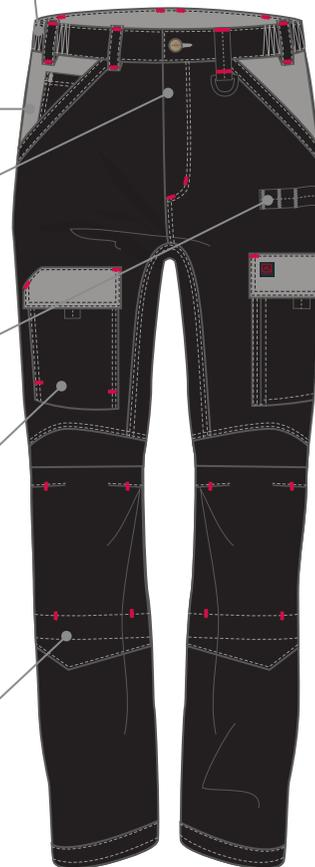
Poches revolver fermées par velcro avec renforts Cordura® et soufflet bas
